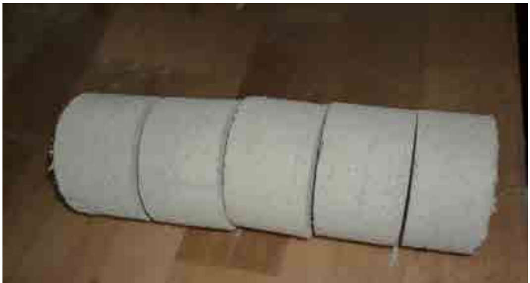
Рисунок 2.3 – Керн з газобетону, розпиляний на окремі зразки
