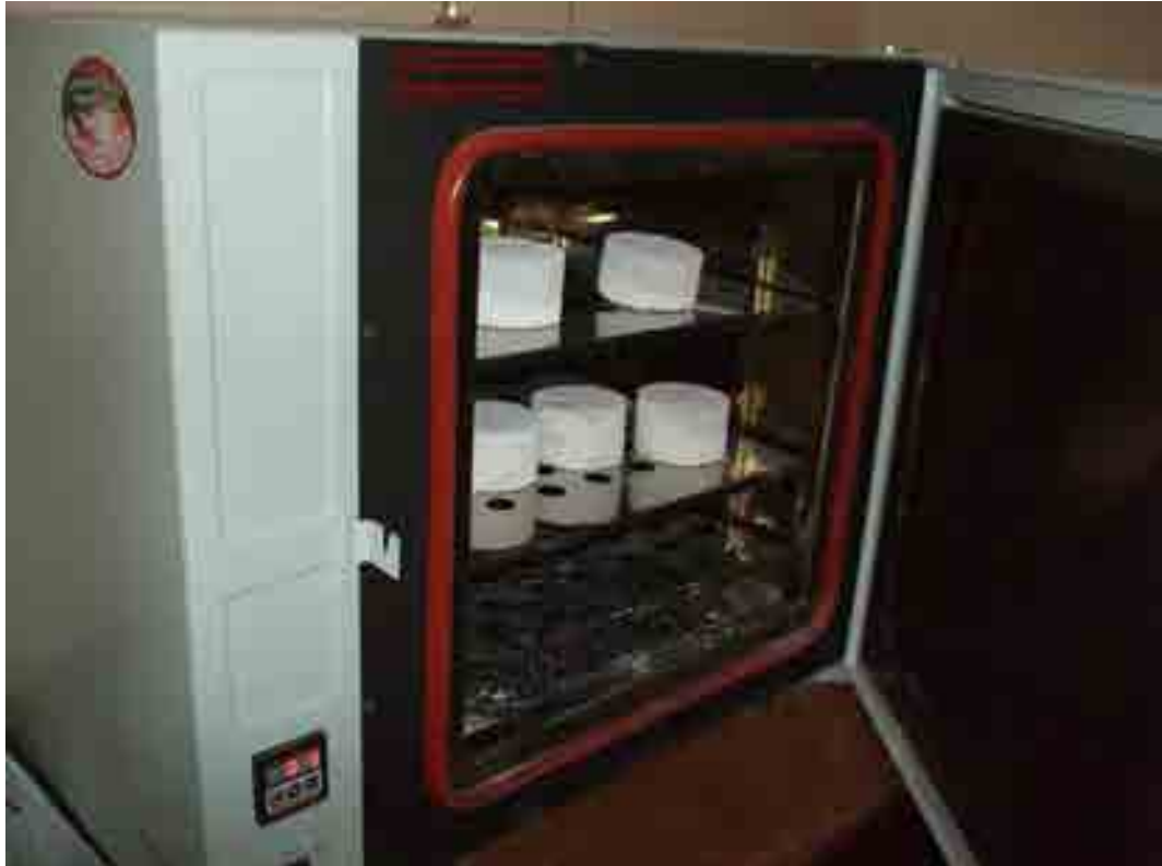
Рисунок 2.6 – Висушування зразків у сушильній шафі
