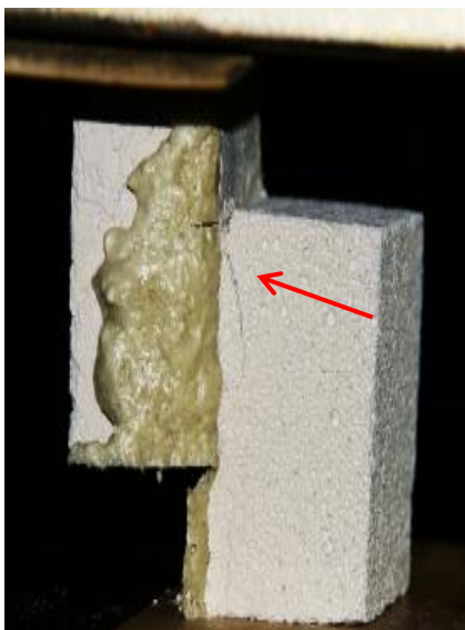
Рис. 4. Начало образования трещины
