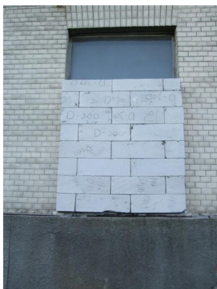
Рис. 1. Схема исследуемых фрагментов стеновых ограждений из ячеистого бетона
