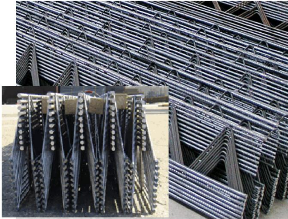
Рис. 3. Треугольные арматурные каркасы на складе завода
