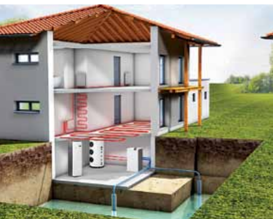
Принципиальная схема теплового насоса типа «вода-вода»
