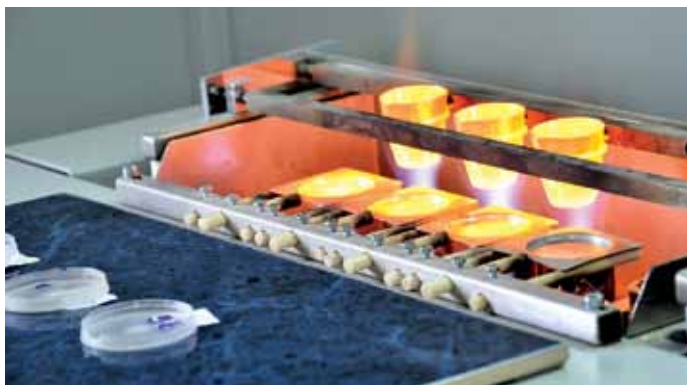
Заводские лаборатории оснащены современным оборудованием от ведущих европейских производителей, среди которого плавильная машина «Вулкан» и приборы «Вика»
