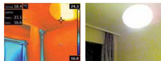
Незначительное снижение температуры в углу
