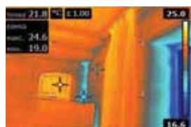
Достаточная изоляция наружной стены. Перепад температур на поверхности внешней и внутренней стен 1,4 °С
