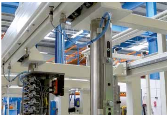
Фрагмент устройства горизонтальной резки с подвижными колоннами
