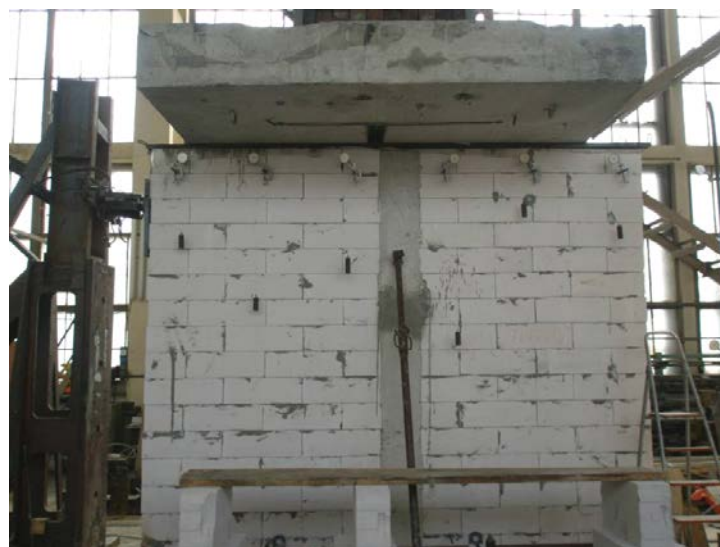
Рис. 3. Схема испытательного стенда с приложением горизонтальной (сейсмической) нагрузки справа при монотонном нагружении (а) и общий вид простенка без сердечника (б) и с сердечником (в), нагруженных вертикальной и горизонтальной нагрузками, при испытаниях
