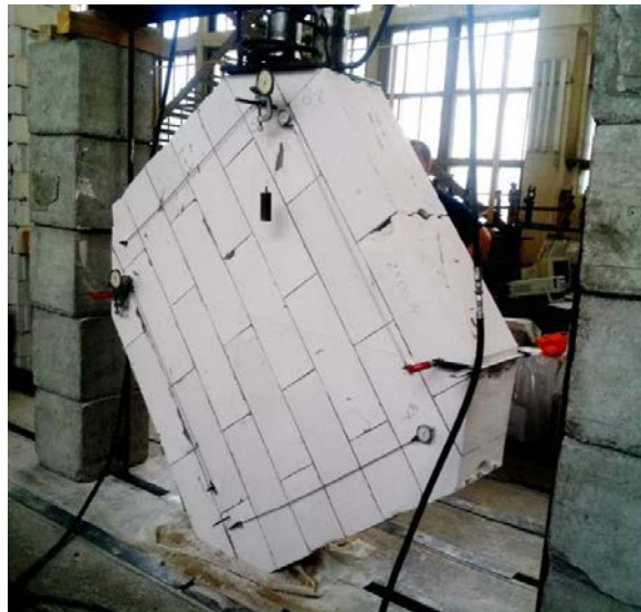
Рис. 5. Общий вид испытаний фрагмента кладки на перекос
