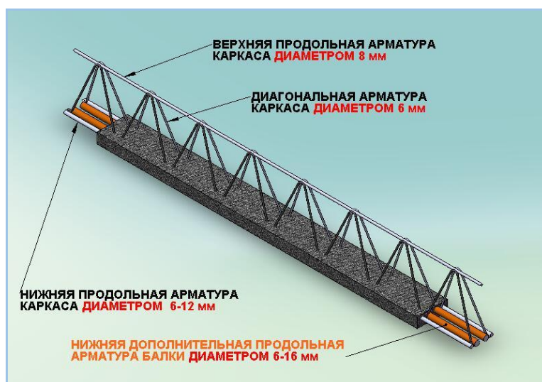
Рис. 6. Схема бетонной балки сборно-моноконтного перекрытия российского производства
