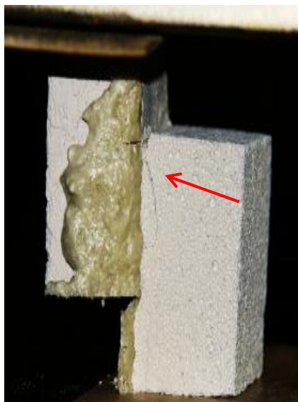
Рис. 4. Начало образования трещины
