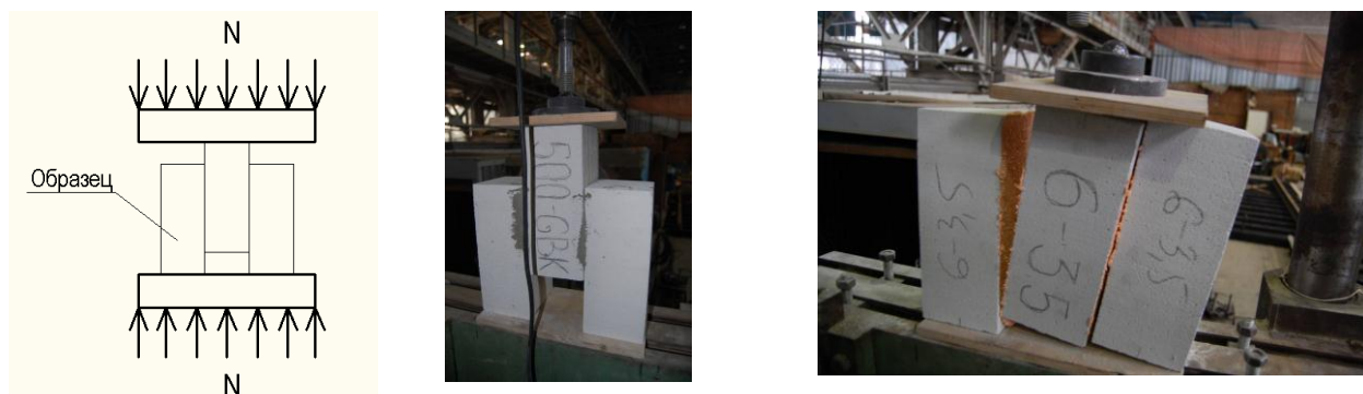
Рис. 2. Схема испытания, общий вид испытательной установки и испытанный образец при определении касательного сцепления в кладочном шве
