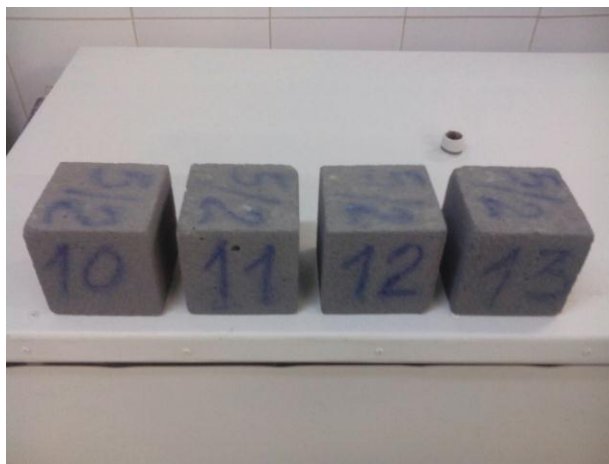
Рис. 1. Образцы газобетона после 100 циклов испытания по ГОСТ 25485-89
