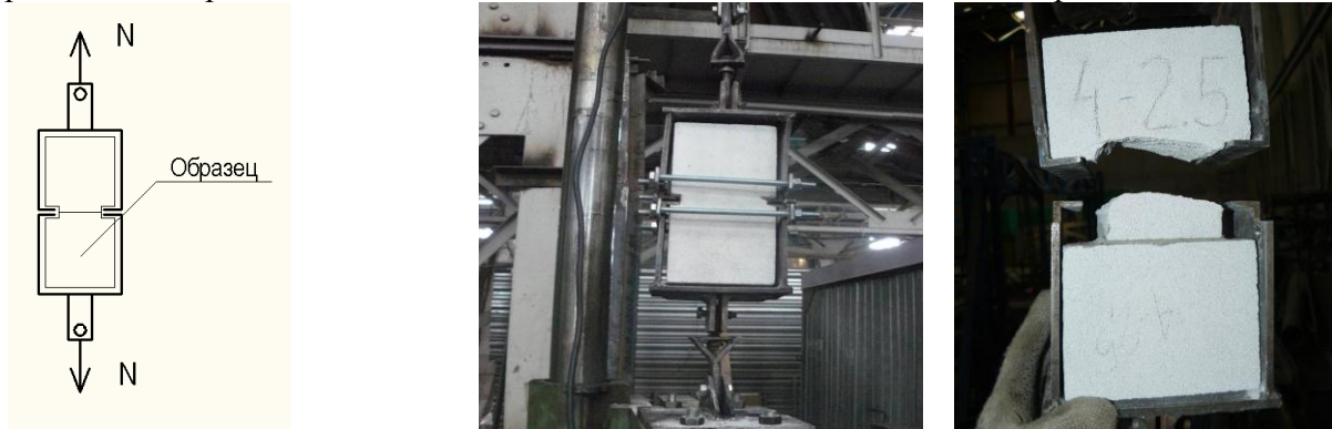
Рис. 1. Схема испытания, общий вид испытательной установки и испытанный образец при определении нормального сцепления в кладочном шве
