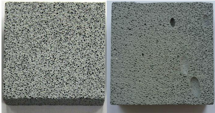
Рис. 1. Образцы газобетона, произведенные по литевой (слева) и ударной технологии
