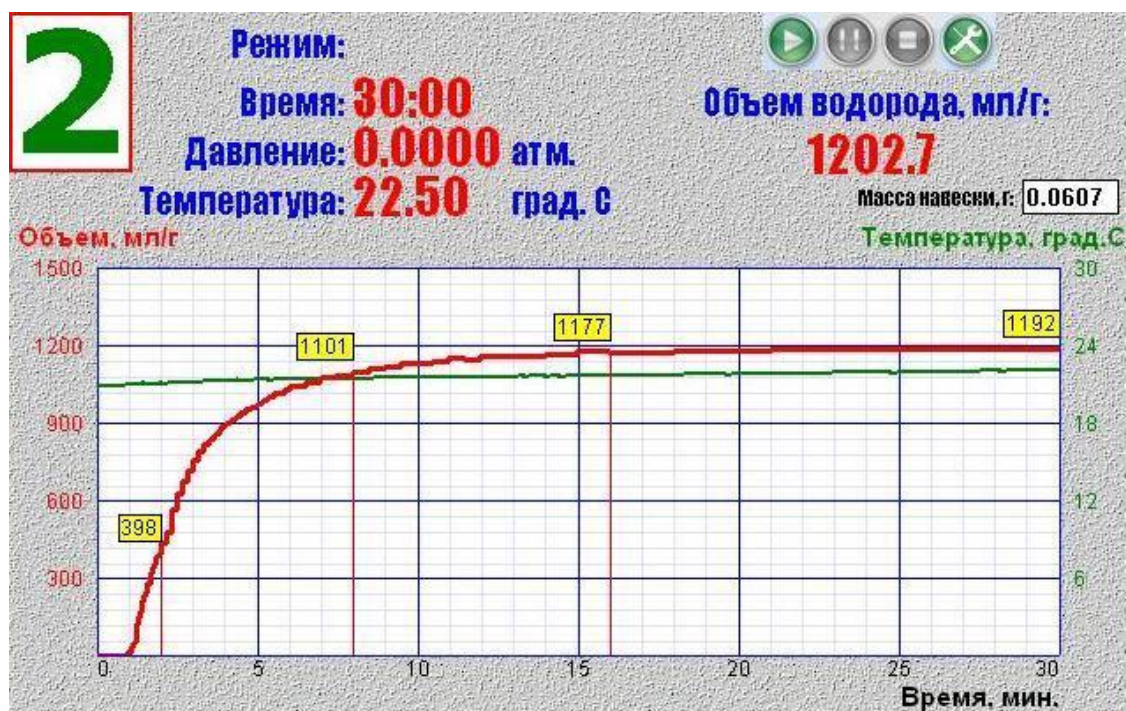
Рис. 3. Построение кривой газовыделения
