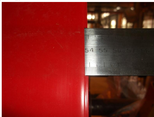
Рис. 1. Определение размера фальцовки
