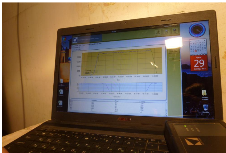
Рис. 1. Общий вид измерительной системы ConTest-8 при контроле производства газобетонных блоков на коломенском заводе "Элгид-ЗСИ"
