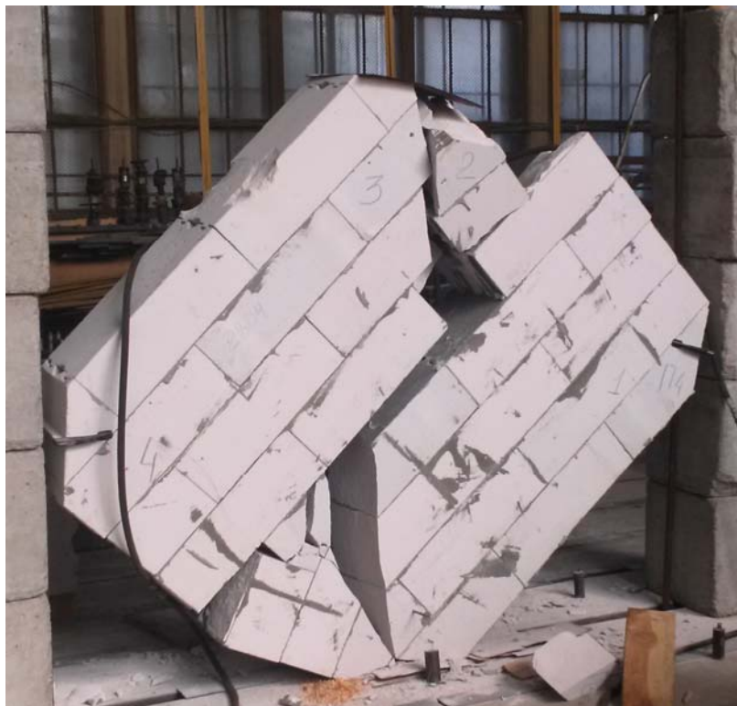
Рисунок 3 Характер руйнування зразків
