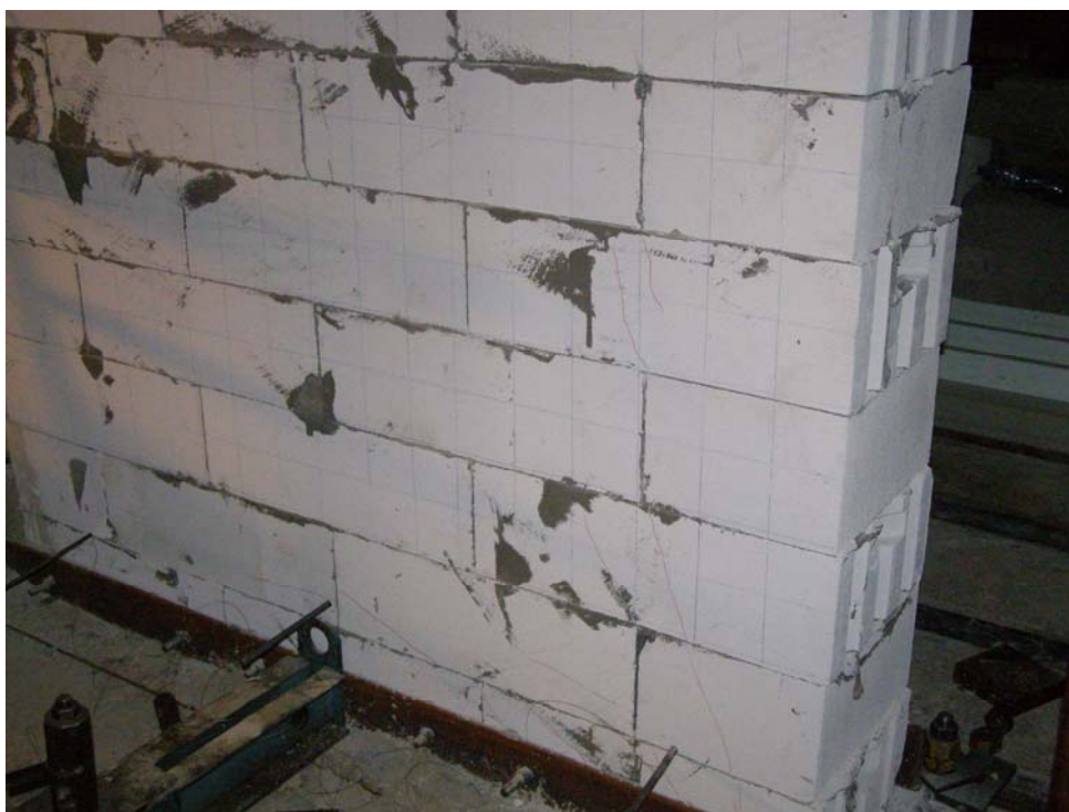
Рис. 15 Характер руйнування зразка №2
