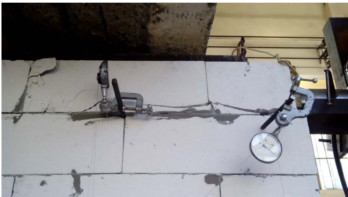
Рис. 8 Характер руйнування зразка №1
