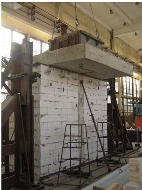
Рис. 3.7 - Простенок размером 3600х3200х375 мм перед началом испытаний
