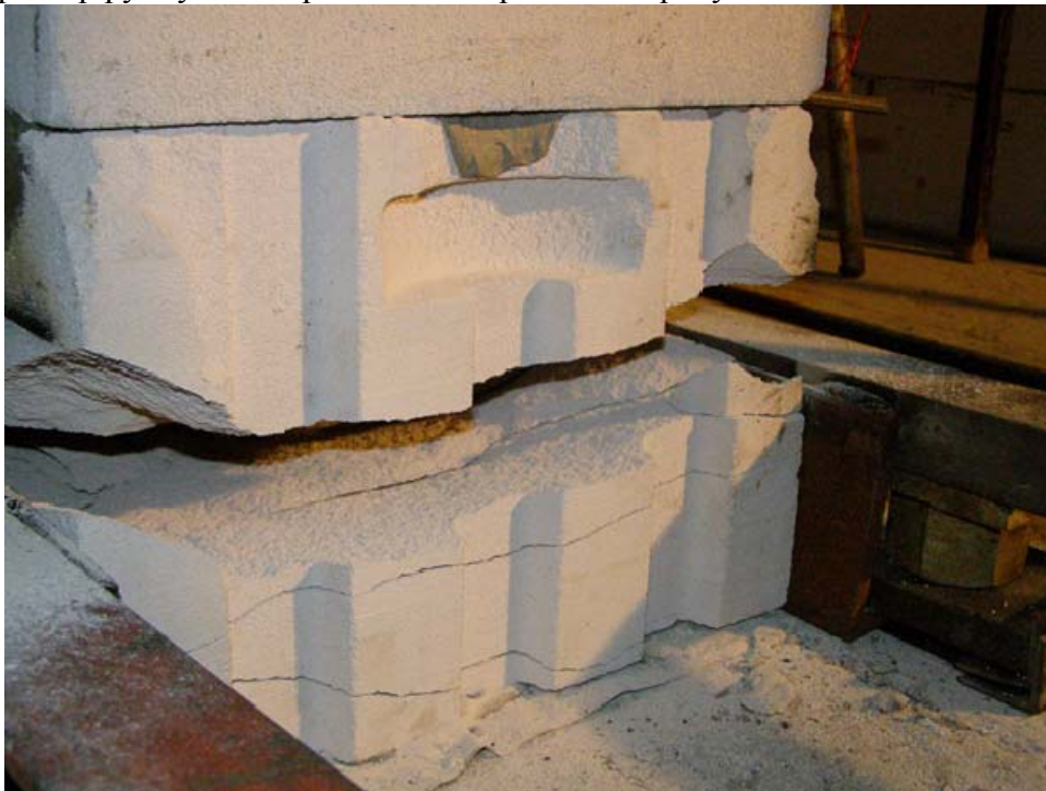
Рис. 14 Характер руйнування зразка №2
