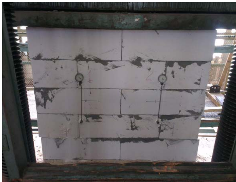
Рисунок 1. Загальний вигляд зразка фрагменту стіни з газобетонних блоків D400 B2,5 7 Тип та основні характеристики випробувального обладнання та засобів вимірювальної техніки.
