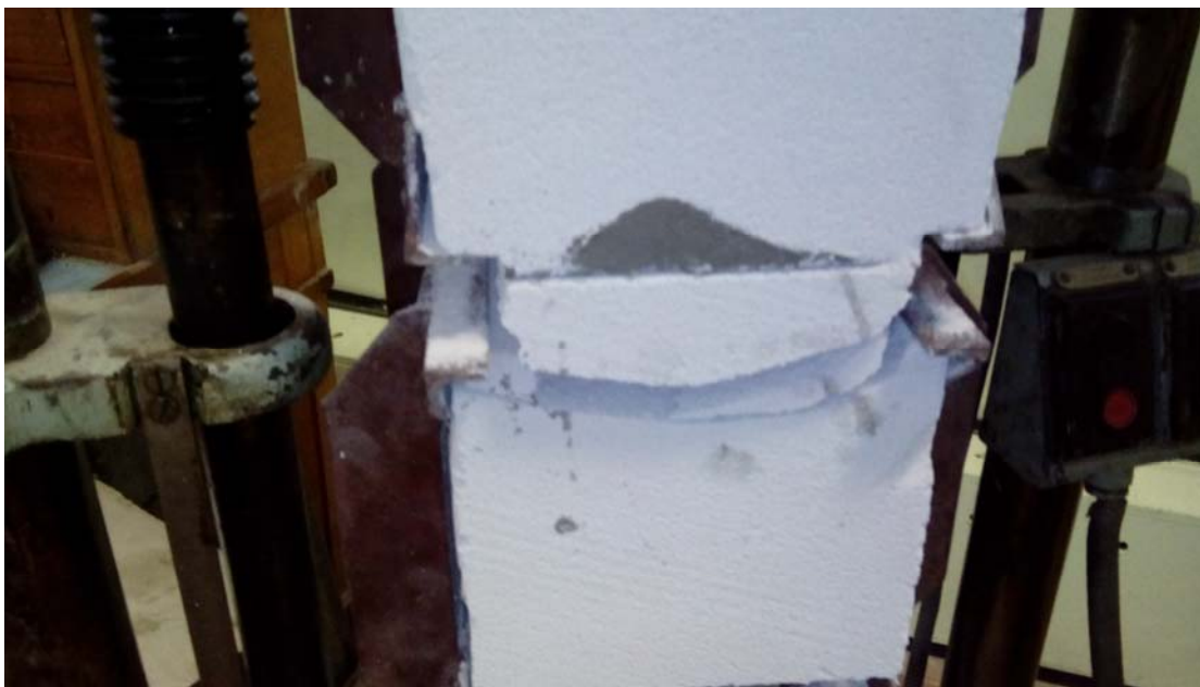
Рисунок 2. Характер руйнування зразків кладки з газобетонних блоків D400 B2,5
