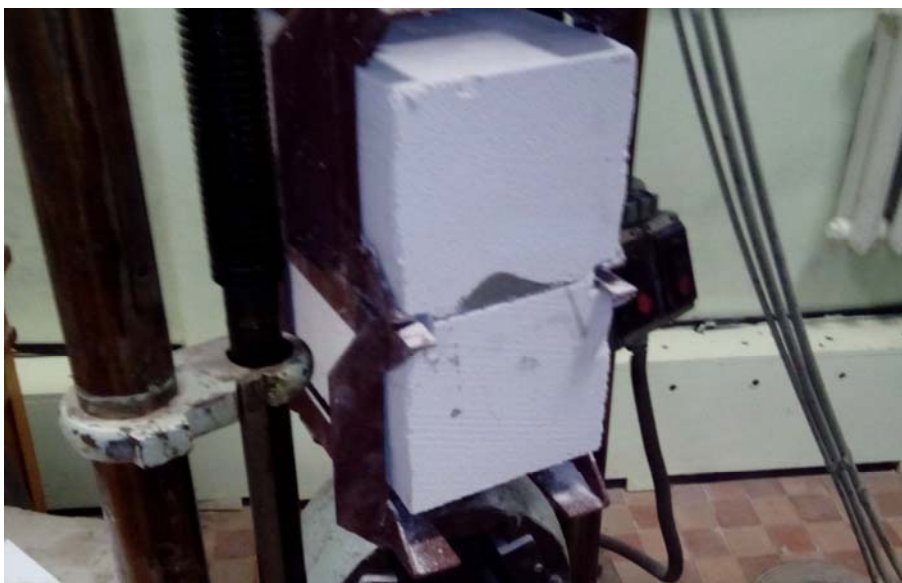
Рис. 3.1 - Образец кладки из газобетонных блоков D400 B2,5 перед испытанием на растяжение
