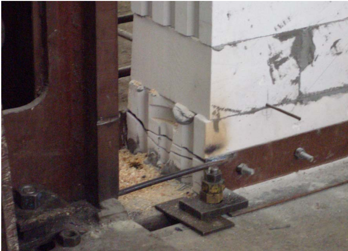
Рис. 22 Характер руйнування зразка №3
