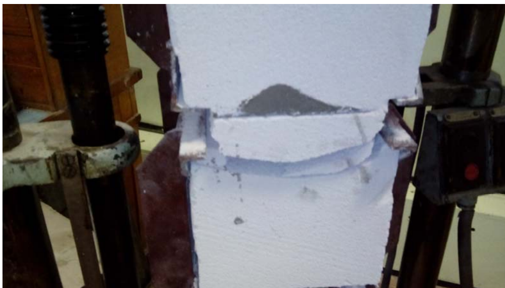
Рис. 3.2 - Характер разрушения образцов кладки из газобетонных блоков после испытания на растяжение
