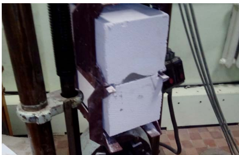
Рисунок 1. Загальний вигляд зразка кладки з газобетонних блоків D400 B2,5
