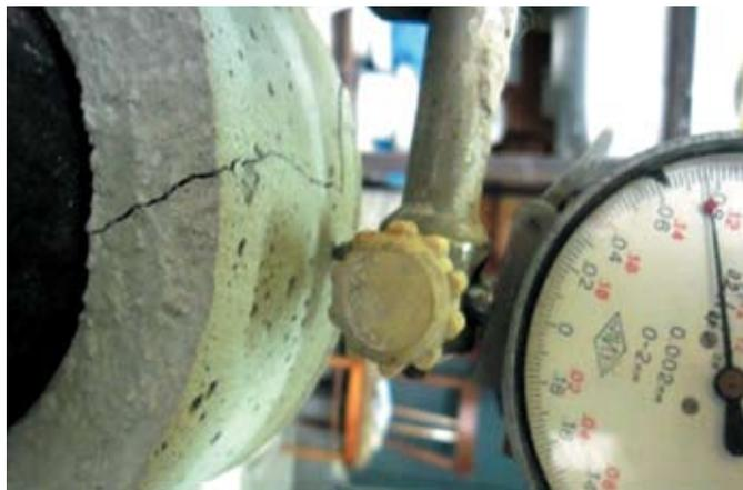
Рисунок 9. Определение трещиностойкости раствора
