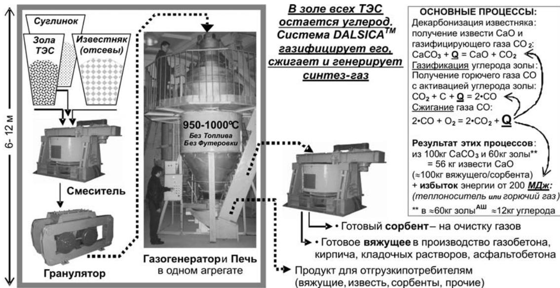
Рисунок 2 - Базовый комплект оборудования для получения автоклавного вяжущего (CaO-SiO<sub>2</sub>-)
