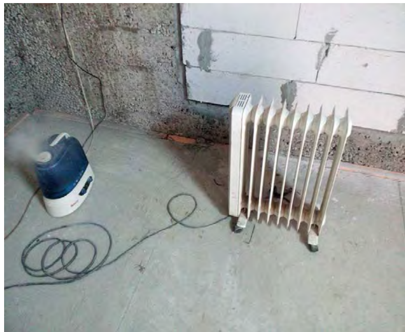
Рисунок 5 –Електричний зволожувач повітря та нагрівальний радіатор
