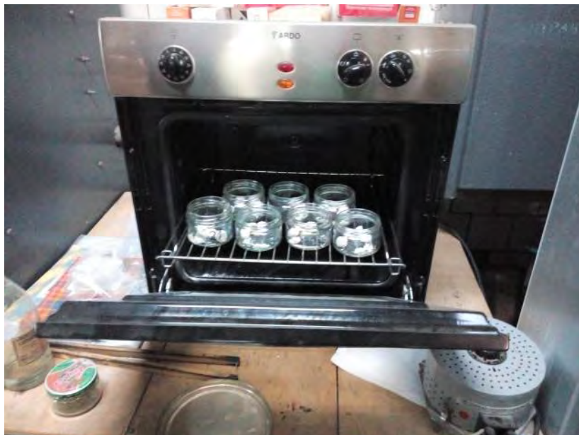
Рисунок 10 –Сушильна шафа для висушування проб матеріалу
