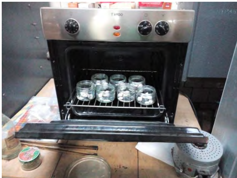
Рисунок 10 –Сушильна шафа для висушування проб матеріалу
