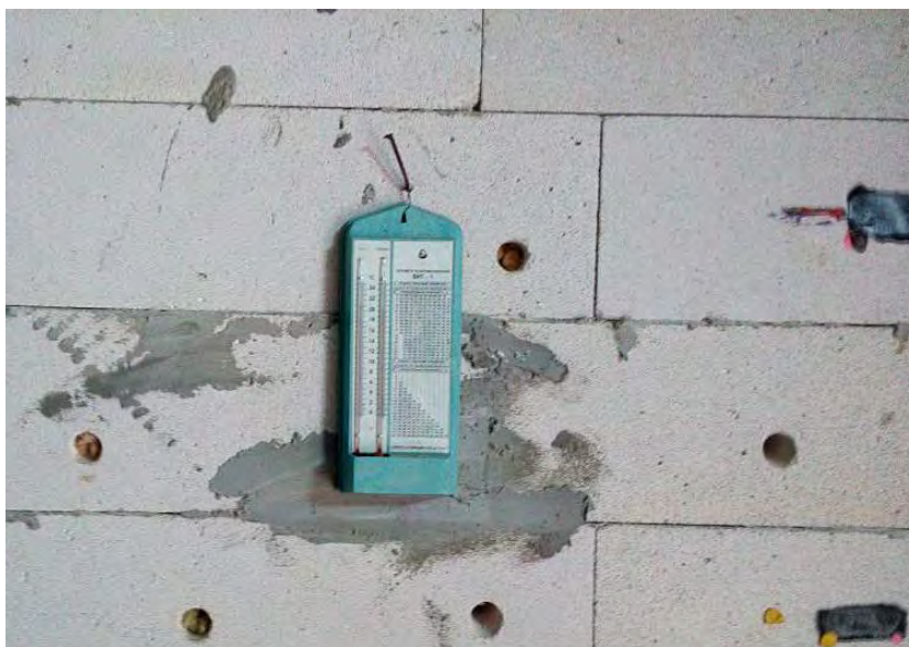
Рисунок 6 –Психрометр для визначення температури та вологості повітря
