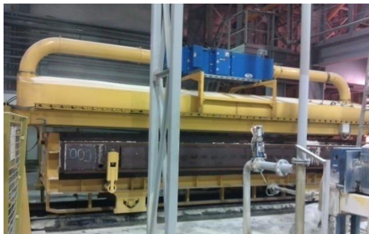
Рис. 5.4 – Установка для смазки форм
