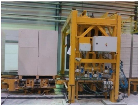
Рис. 5.20 – Линия упаковки готовой продукции
