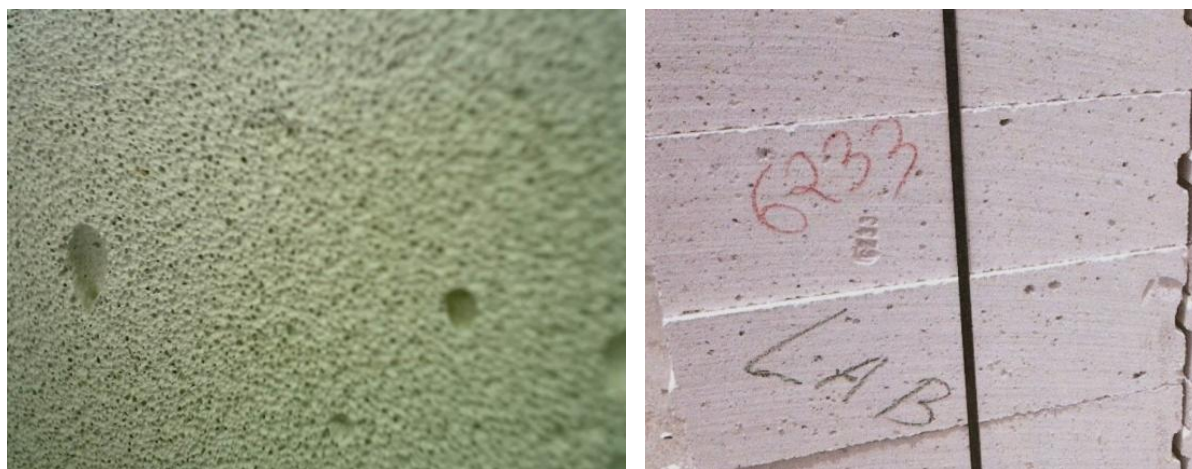
Рис. 5.29 – Крупные пустоты и линзы в ячеистом бетоне
