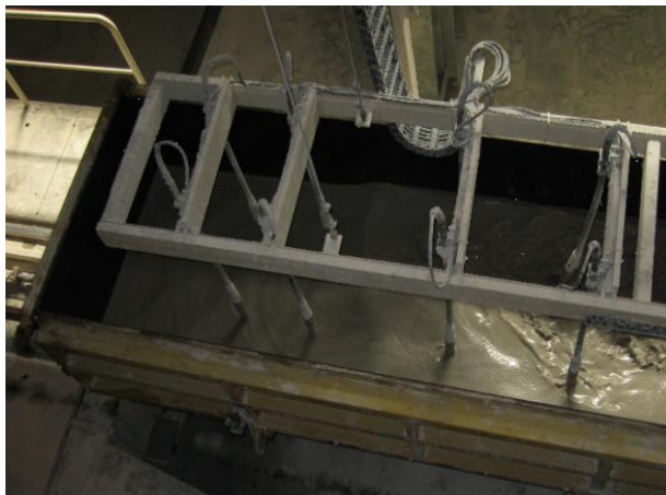
Рис. 5.6 – Виброрешетка для заливочной смеси
