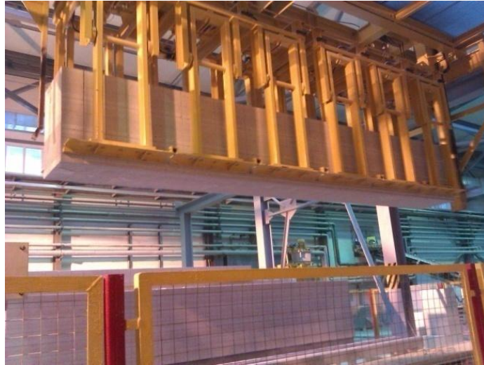
Рис. 5.19 – Кран перестановки массивов на линию упаковки
