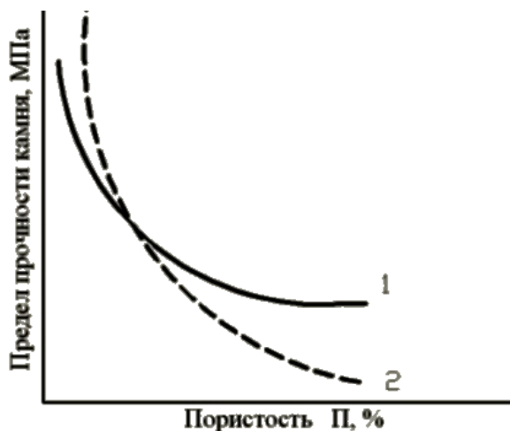
Рис. 4.3 – Графики зависимости прочности газосиликатного камня от его пористости 1 – низкоосновные гидросиликаты кальция; 2 – высокоосновные гидросиликаты
