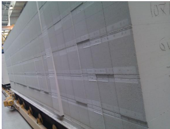
Рис. 5.43 – Внешний вид массива, разделенный неисправным делителем
