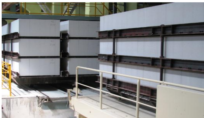
Рис. 5.14 – Комплектование автоклавных тележек «горизонтальными» массивами
