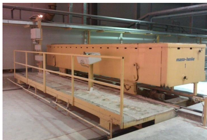
Рис. 5.9 – Трансбордер с формой
