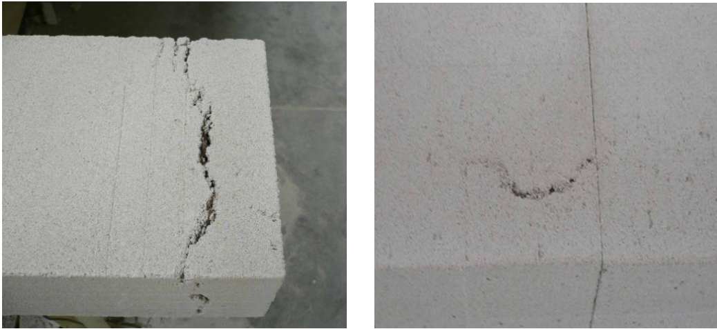
Рис. 5.28 – Трещины, возникшие из-за несоответствия скоростей роста объема массива и его твердения
