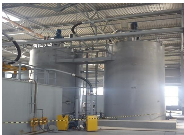
Рис. 5.2 – Шламбассейны прямого шлама
