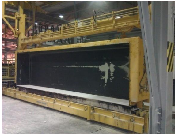
Рис. 5.10 – Кран-кантователь для распалубки и установки массивов на линию резки
