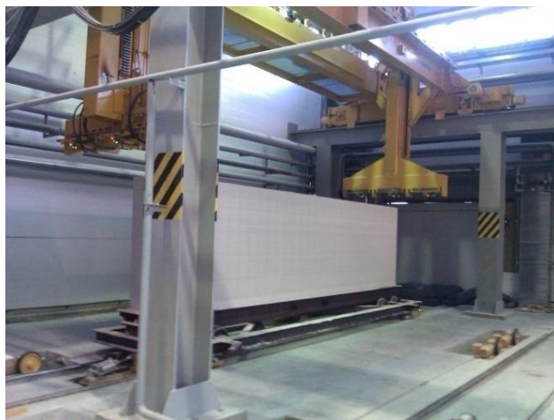
Рис. 5.17 – Кран-манипулятор для перестановки массивов на линию деления
