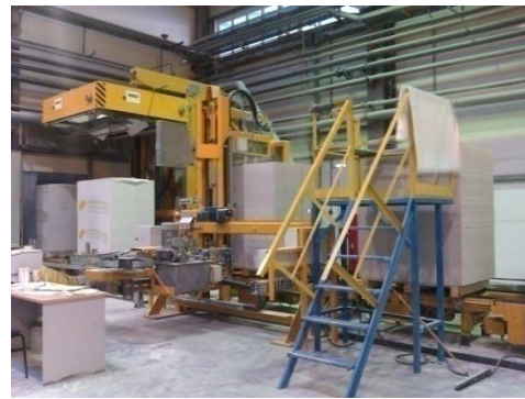
Рис. 5.20 – Линия упаковки готовой продукции
