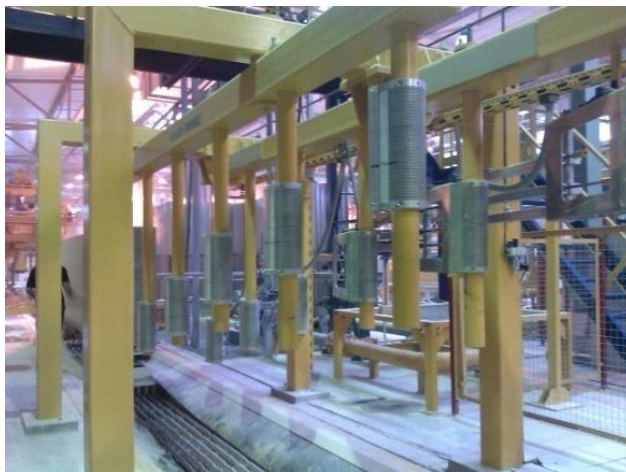
Рис. 5.12 — Машина горизонтальной резки массивов
