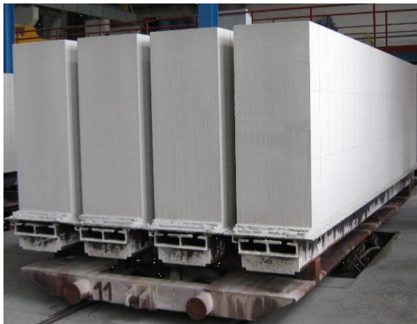
Рис. 5.15 – Вертикальная комплектация автоклавных тележек
