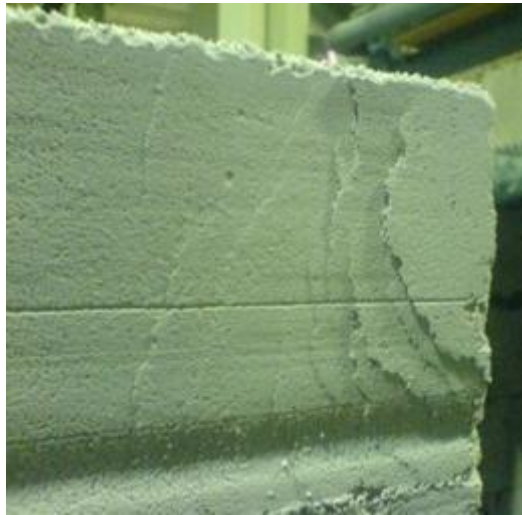
Рис. 5.35 – Дефекты изделий в результате резкого изменения режима автоклавной обработки (из [264])
