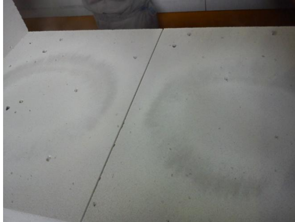
Рис. 5.36 – Темные пятна на изделиях после автоклавной обработки
