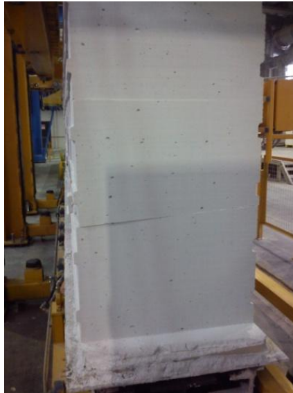
Рис. 5.34 – Косой рез массива, в результате неправильно установленных струн
