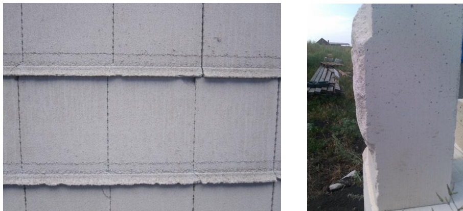
Рис. 5.42 – Изделия, с не отделившимся подрезным слоем
