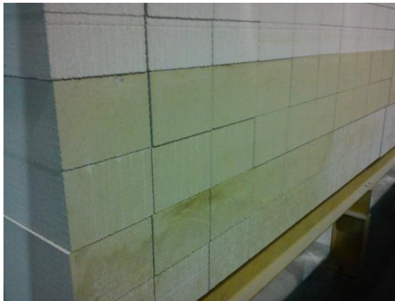
Рис. 5.31 – Масляные пятна на готовой продукции
