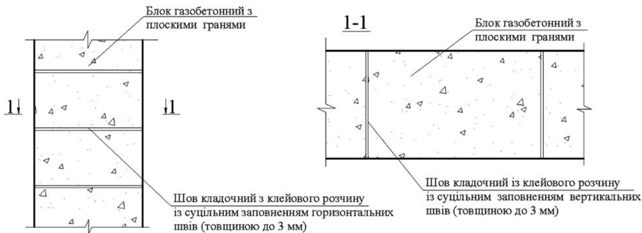
Рисунок 7.1 – Одношарова кладка стін будівель із газобетонних блоків з плоскими гранями і суцільним заповненням горизонтальних і вертикальних швів
