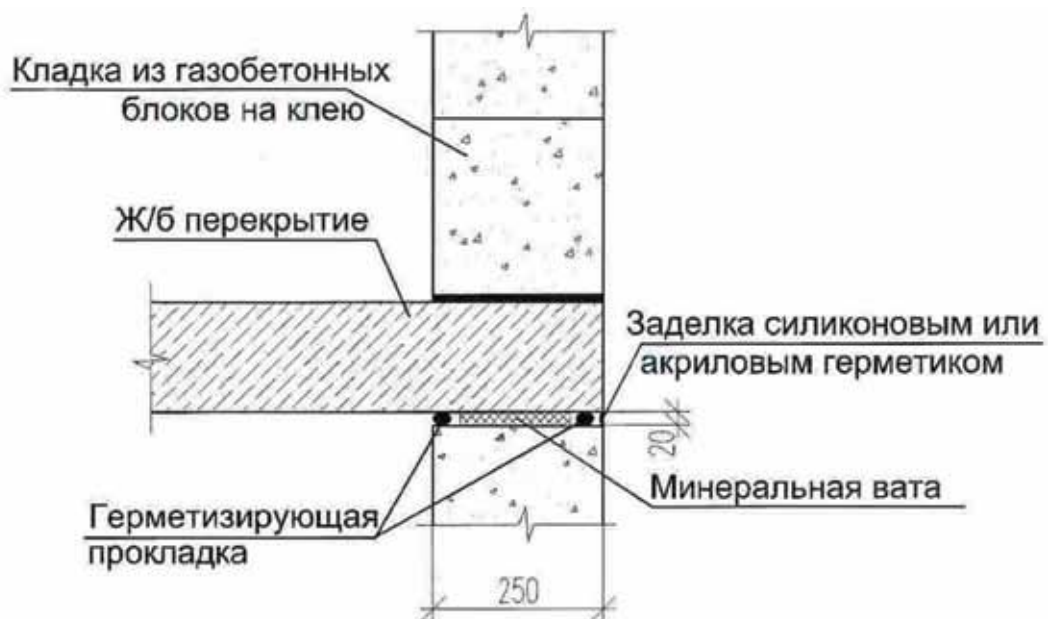
Рисунок 6. Схема устройства верхнего края кладки в месте ее примыкания к монолитному перекрытию
